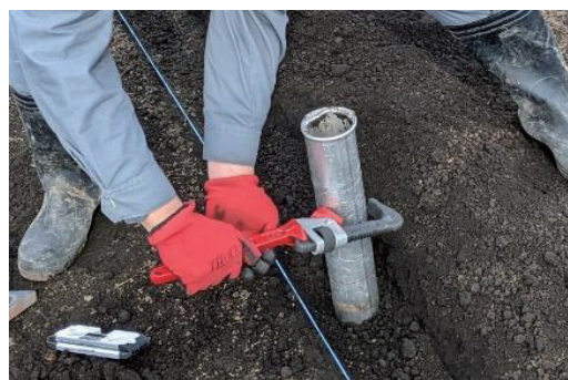
第6図 パイプレンチを用いた鉄パイプの引き抜き。ハンドオーガーで土壌を掻き出した鉄パイプをパイプレンチにより引き上げた。
