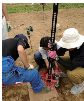
第5図 ジャッキを用いた鉄パイプの引き抜き。木板の上に置いたジャッキにより鉄パイプに挿入した銅棒をジャッキアップし、鉄パイプを引き抜いた。
